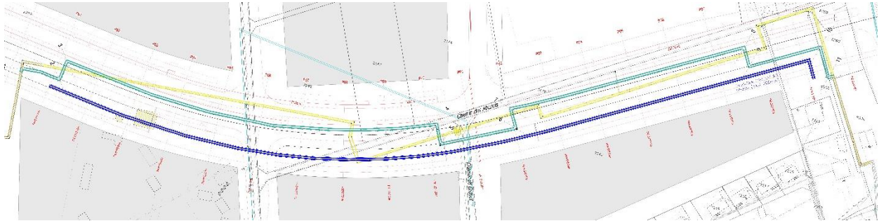
Figure 15: Dévoiement du CADIOM (ancien tracé en jaune, futur tracé en bleu clair) et tracé prévu pour le projet de CAD SIG Rive Gauche (bleu foncé)
